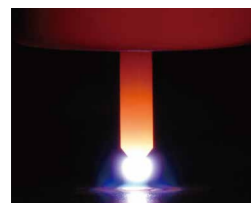
タンクステン電極径1.0mm 溶接条件:溶接電流2A
